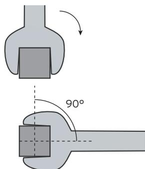
No caso do parafuso com 8 lados, a chave deve ser girada em 45°. Mas pode-se verificar pela ilustração abaixo que uma figura com 8 lados (ângulo interno de 135°) está mais próxima de uma circunferência do que uma figura com 6 lados (ângulo interno de 120°).
